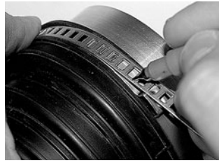
Paso 2 Determinar la longitud de la abrazadera.
