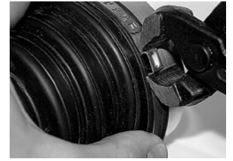
Etapa 4 Colocar a abraçadeira sobre o objeto. Engatar os ganchos do fecho na posição mais justa possível. Apertar firmemente a orelha utilizando um Alicate Oetiker.
